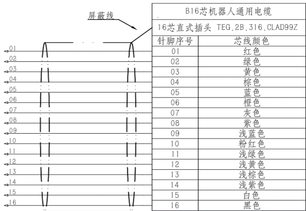
图 4-8 第二机械臂 CS 接线图
